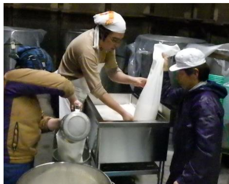
開発した小型しぼり機。試作品量に合わせたサイズで、効率の良いしぼり作業を実現。
