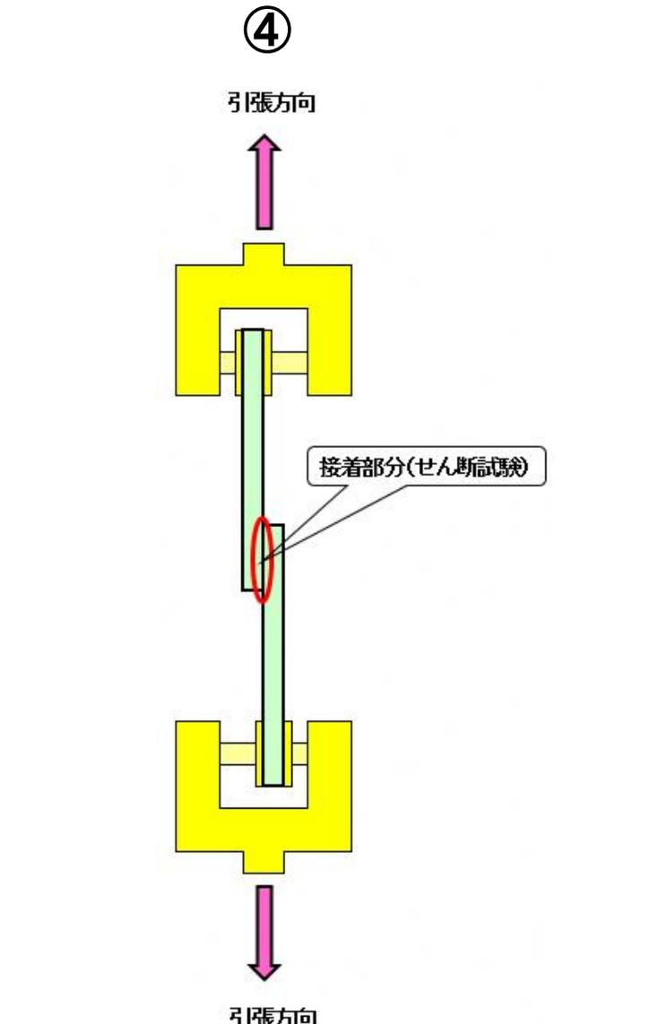
〔インストロン製エアチャックの場合は、つかみ部の厚みを増やさず**オフセット引張試験**を行うことで接着せん断試験を行うことが可能〕
