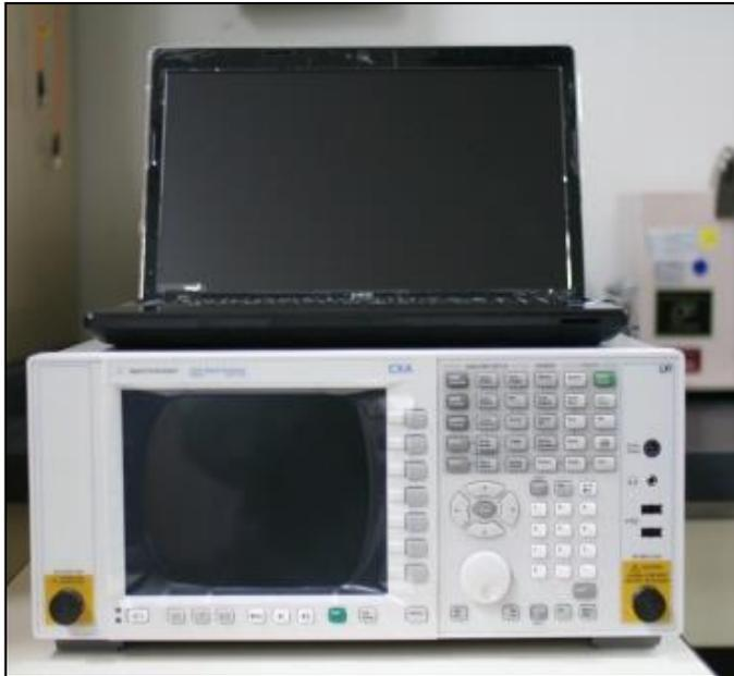
**電磁波シールド特性測定システム**
