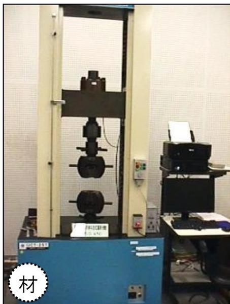
**万能材料試験機 <250kN>**
