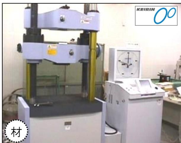
**万能材料試験機 <1000kN>**
