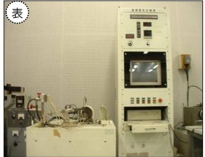
**回転動摩擦摩耗試験機**
