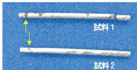
図4 腐食試験後の外観（↑↓はテフロン糸結束部）
