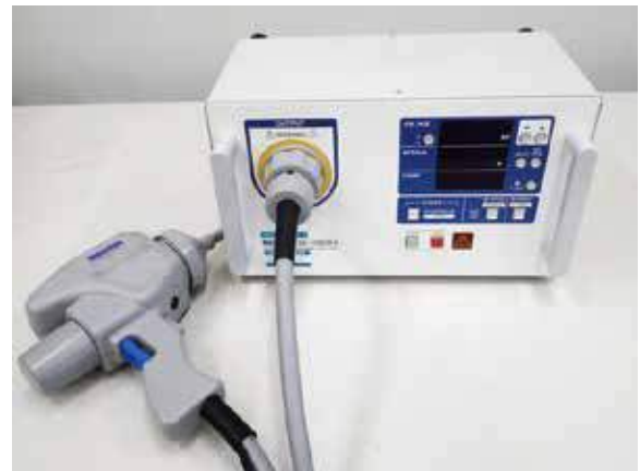
図3 静電気放電試験機
