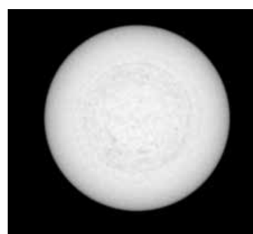
図3 再生成した透過画像から補正を行って再構成したアルミ円柱の断面画像
