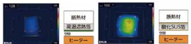
ヒーター(400°C)上に空間を設け、高温遮熱箔、酸化SUS箔を設置。断熱材を重ね、表面温度をサーモカメラで測定。高温遮熱箔(左図)は酸化SUS箔(右図)と比較し、30°C表面温度が低下。
