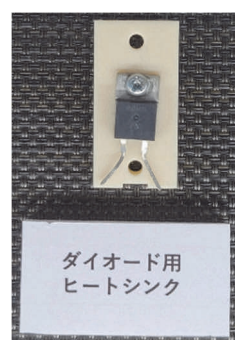
図1 ダイオード(T0220 パッケージ)に取り付けたアルミナ製放熱素子(20mm×40mm×6mm)
