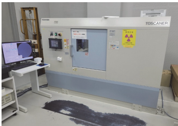
図1 X線CTシステム TOSCANER-32300 \mu FD; 東芝ITコントロールシステム製
