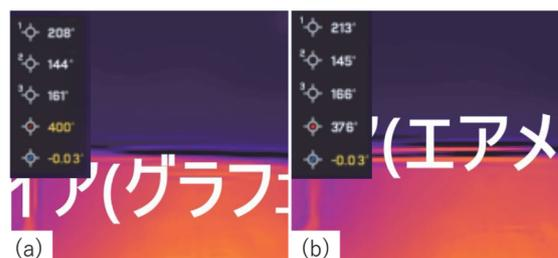
図5 単層グラフェン薄膜による熱伝導促進効果の有無(サファイア基板)
