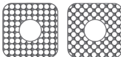
図4 衝撃モデル (左:0度 右:45度)
