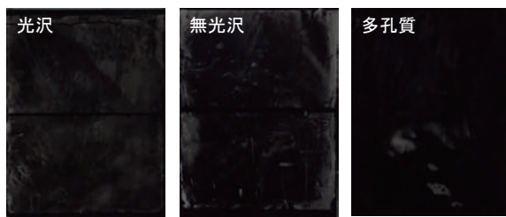
図2 はく離後のめっき外観写真
