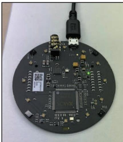
図2 スマートスピーカー基板
