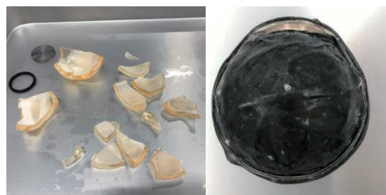
図4 凍結昇圧後の容器 (左：樹脂単体、右：炭素繊維巻)
