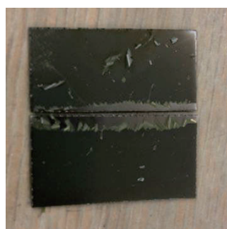
図10 600°C、2時間熱処理した結果
