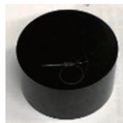
図7 導電性樹脂による包埋
