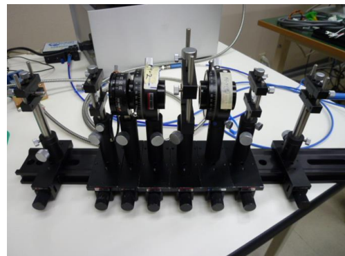
図5 空間位相変調器位相シフト評価系
