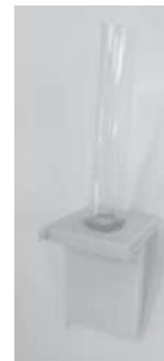
**図1 離型性評価試験片写真**
