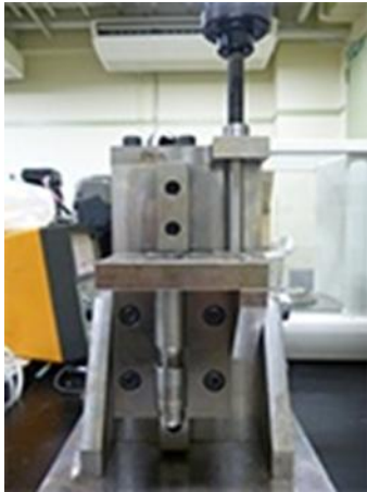
図 2 静的押し付け試験機
