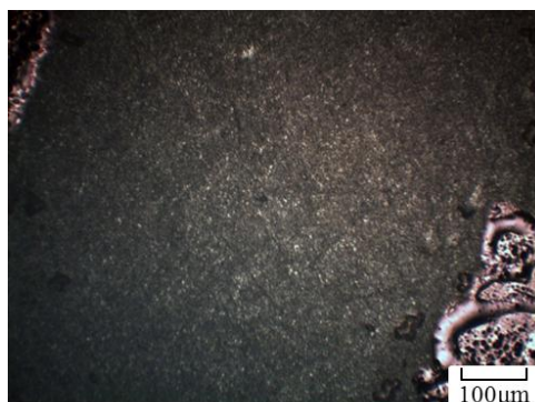
(a) 押し付ける前の DLC 膜の様子
