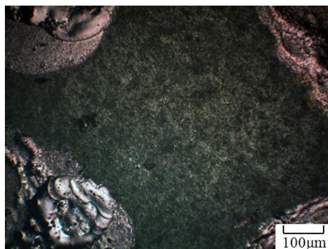
(d) 45N で押し付けた後の DLC 膜の様子
