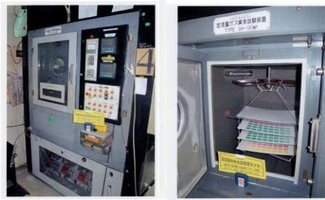
図2 環境汚染混合ガス処理試験状況（山崎精機研究所）
