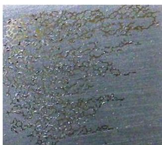
図 1 成膜直後から剥離した DLC 皮膜 (成膜条件①)
