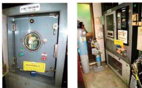
・試験内容 3種混合耐ガス試験【H2S+NO2+S02】 ・試験装置(株)山崎精機研究所 定流量フロー形ガス腐食試験装置GH-180形 ・試験条件 試験ガス・濃度 H2S-5ppm, NO2-10ppm, S02-10ppm 試験温度・湿度 30.0℃・99%RH 試験日数・時間 4日間【96h】 図4 環境汚染混合ガス試験装置
