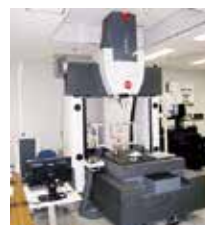
図2 三次元座標測定機(CMM)
