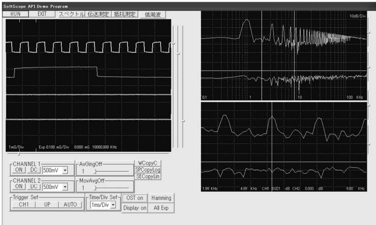
図7 方形波とその高調波スペクトル分布の解析結果
