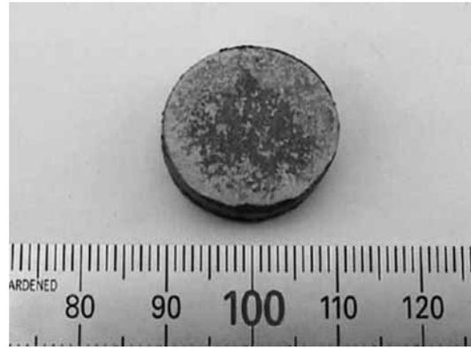
写真1 プラズマ放電焼結したMg<sub>2</sub>Si焼結体の外観
