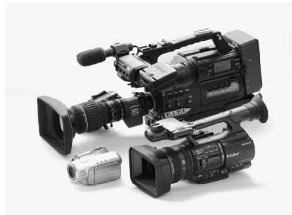
写真1 取材に使用される業務用カメラとそのサイズの比較。奥がENG(ショルダータイプ・大型)カメラ、手前右がハンディタイプ(中型)、手前左が家庭用小型カメラ。使用した「HDR-FX1000」は手前右中型カメラ
