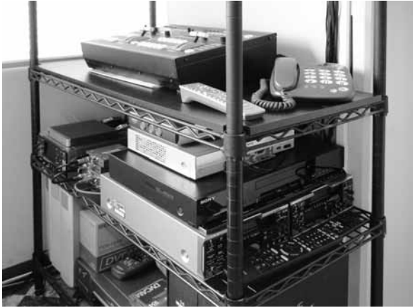
写真1 ハイビジョン会議システム端末 (PCS-XG80)・変換機 (ADVC-HD50、Mini Converter)・スイッチャー (V440-HD)・録画機 (HVR-M25A、PMW-EX30) 等で構成されたアーカイブシステム
