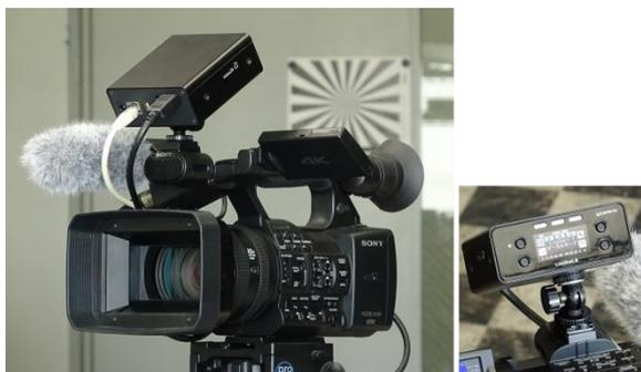
**業務用カメラに直接搭載した例（バッテリー運用も可能）**
