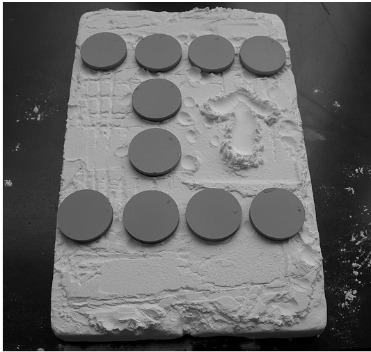
写真2 プレス成型試料
