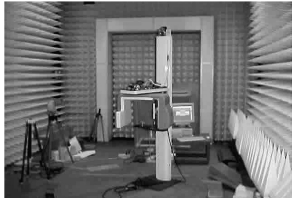
写真1 放射ノイズ対策のための評価試験の試験配置
