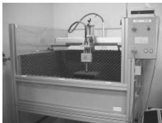
図1 アンテナ近傍界放射パターン測定装置
