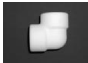
写真1 RPを用いた試作(抜き勾配無し)
