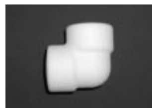
写真2 RPを用いた試作(抜き勾配有り)
