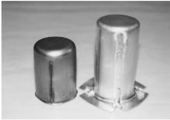
写真2 接合例（左からSPCC材のレーザー ビーム溶接、A1050 - O材のTig溶接）
