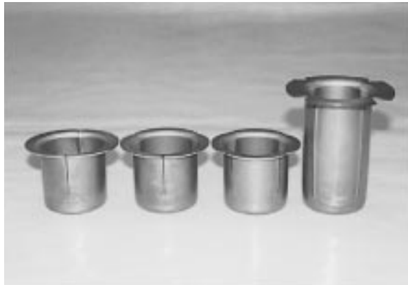
写真1 SPCC板の成形品例 (左から 110mm 分割数 2, 3, 4, 180mm 分割数 4)
