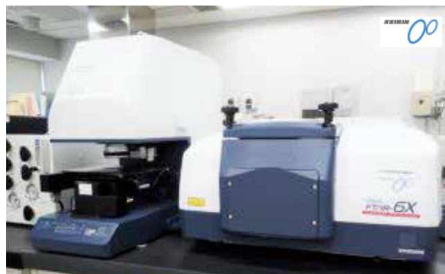
フーリエ変換赤外分光光度計(FT-IR) プラスチック等の有機化合物の定性分析ができます。 (令和5年度JKA機械補助事業)
