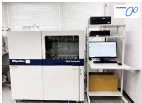
波長分散型蛍光X線分析装置 各種材料中の元素の定性分析及び定量分析ができます。 (令和4年度JKA機械補助事業)
