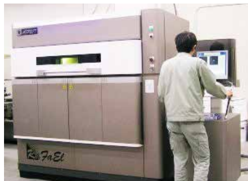
高速三次元成形機(樹脂粉末積層3Dプリンタ) 三次元CADデータから立体モデルを作成します。
