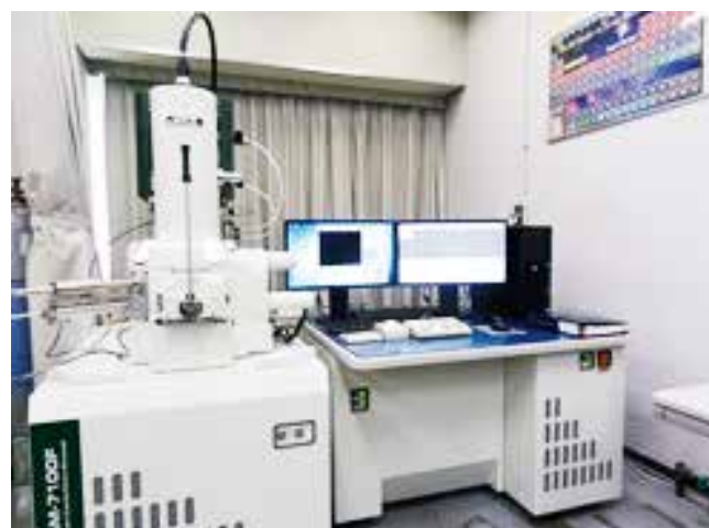
分析型走査電子顕微鏡 各種材料の微細構造の高倍率観察及び元素分析ができます。
