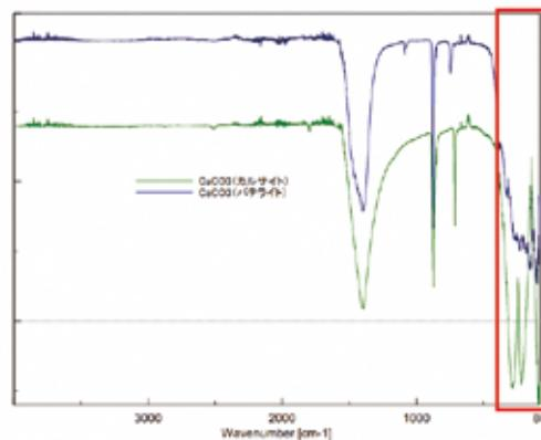
図4 CaCO<sub>3</sub>のスペクトル
