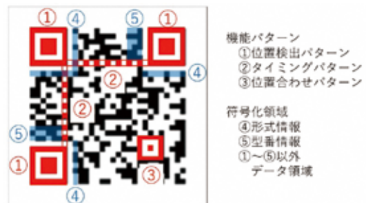
図1 QRコードシンボルの構造
