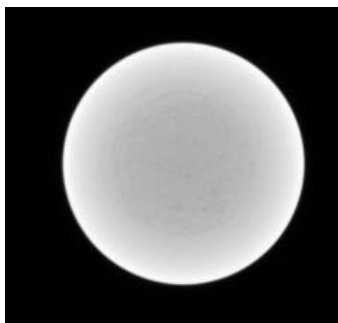
図1 アルミ円柱断面画像
