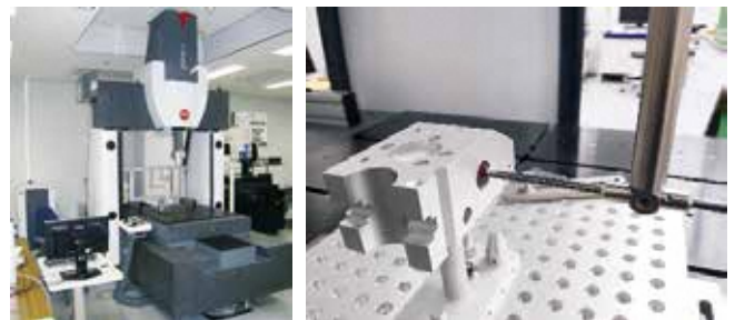
図3 CNC三次元座標測定機による測定
