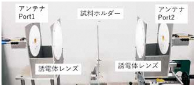
図1 フリースペース法測定システム
