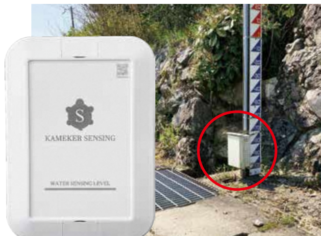
センサー本体(左画像)と外装ボックス(赤マル印)に入れての設置
