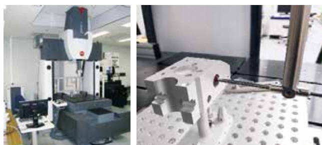
図3 CNC三次元座標測定機による測定
