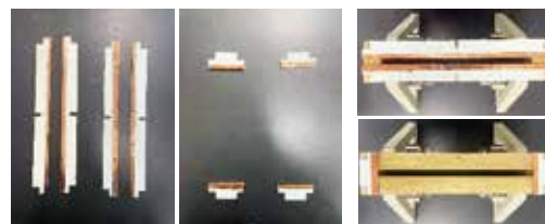
図4 1軸導通処理サンプル(長手(左)と短手(中央))とサンプルの設置状況(右)
