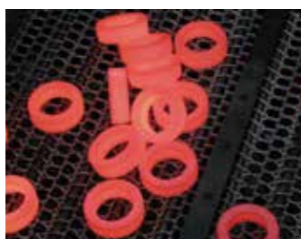
高温で成型されたベアリング
