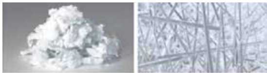
繊維状窒化アルミニウム単結晶「Thermalnite」
