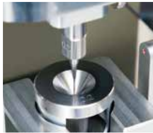
すり鉢状の容器の底から種子を突き上げる仕組み
