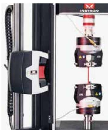
フィルムなど、接触式伸び計が使用できないサンプルの伸び測定が可能です。
