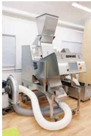
粉体、軽比重物用異物除去装置(右)とその構造(上)
