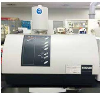
図1 熱伝導率測定装置
