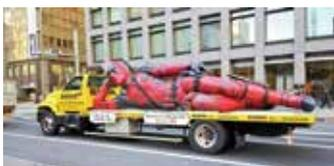
2016(平成28)年には、映画宣伝トラックに載せる全長約7mのキャラクターを制作。3Dスキャニング、3Dデータ作成からCNC工作機による切削、彩色までを一貫して請け負う
