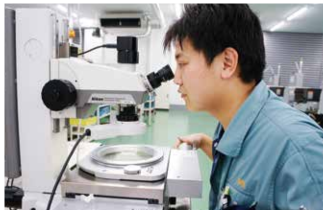
肉眼では見えない微細加工を顕微鏡で確認
