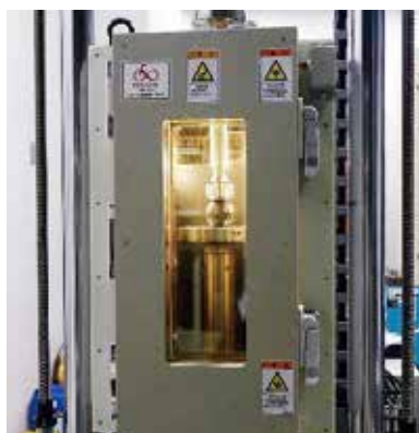
恒温槽内での圧縮疲労試験
