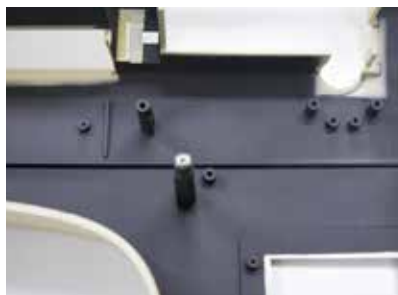
筐体内面に施された導電塗装
